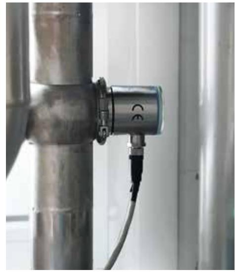
Компактный рефрактометр без выступов
