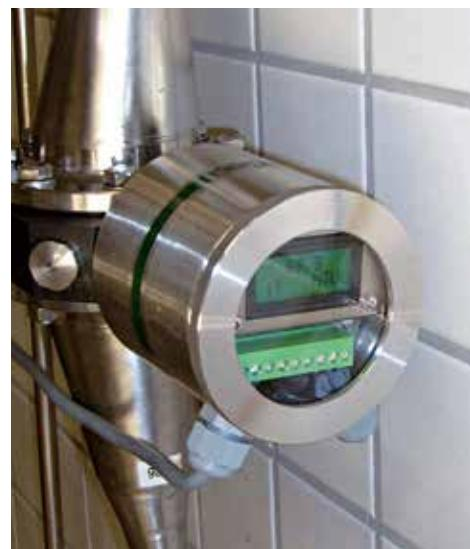
Датчик мутности (4-х потоковый прерывистый свет)
