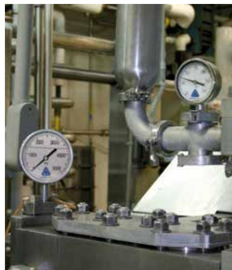
**Манометр со встроенным передатчиком для гомогенизаторов**
