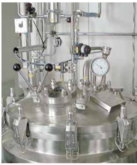
Температурный датчик с асептической монтажной системой PHARMAadapt EPA
