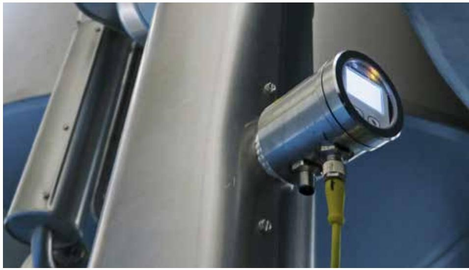
Индуктивный датчик проводимости в модульном исполнении
