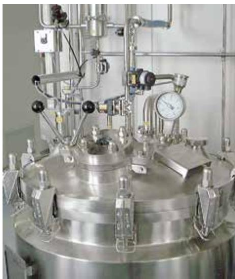
Компактный манометр 63 мм
