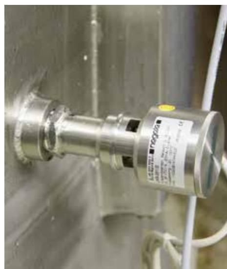
Устойчивый к воздействию температуры и агрессивных сред датчик уровня наполнения с гигиеническим соединительным разъемом CLEANadapt
